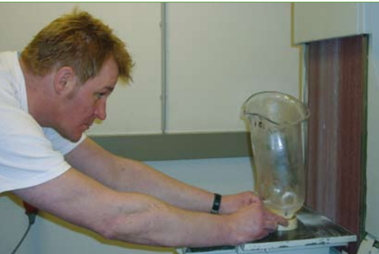
Orthopädiemechaniker stellen die Prothese individuell im Handwerk her. Orthopädietechniker wie Jörg-Michael Vogt der Fa. Karl Zieger aus Dortmund wenden vergleichsweise viel Zeit für den Amputierten auf. Auf diesem Bild ist zu sehen, wie ein Testschaff aus durchsichtigem Kunststoff an der Schleifmaschine bearbeitet wird.
