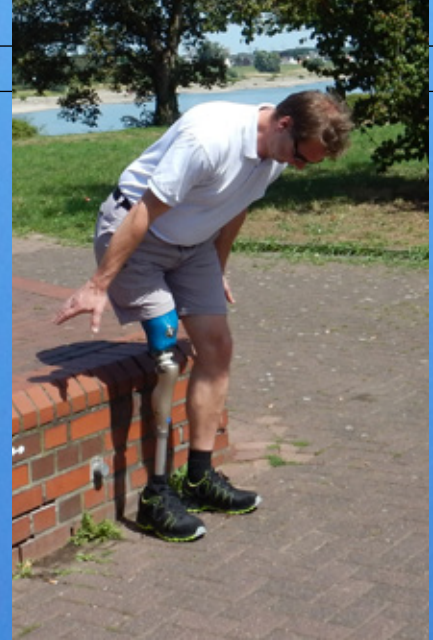
Kenevo erkennt die Absicht des Anwenders, sich hinzusetzen und erzeugt beim Beugen einen Widerstand. Anders als bei den meisten anderen Gelenken wird dieser Widerstand mit zunehmendem Beugewinkel größer und verhindert so ein „Plumpsen“ auf die Sitzgelegenheit. Das ist gerade bei (stein-)harten Sitzflächen von Vorteil.
