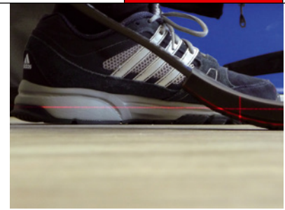
Kontrolle der gewählten Position des Fußes im eingebauten Zustand mit Doppellaserbau
