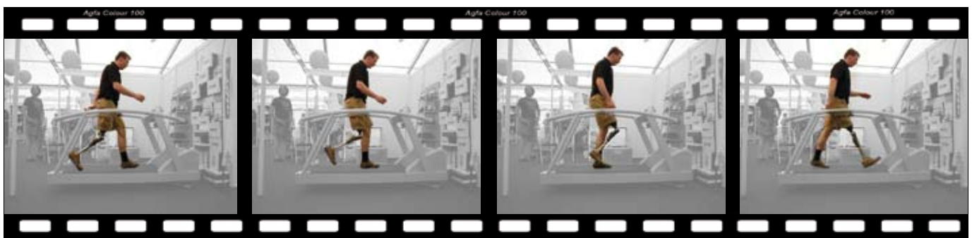
6 km/h: Der Autor in der gleichen Situation wie oben, nur bei der dreifachen Gehgeschwindigkeit. Interessant ist, dass sich zwar Körperhaltung und Bewegungsgeschwindigkeit deutlich verändern, nicht jedoch die Gelenkwinkel und die Schrittlängen. So kommt es zu einem geringfügig geringeren Kniewinkel bei Zehenablösung (1), zu einem etwas höheren maximalen Beugewinkel (aktiv begrenzt durch das computergestützte Kniegelenksystem) (2), zu einer größeren Bodenfreiheit in der mittleren Standphase (3) und zu einem etwas längeren Schritt (4). Der Unterschied im Bewegungsausmaß der Gelenke bei niedrigen und hohen Gehgeschwindigkeiten ist also überraschend gering. Jedoch sind die einwirkenden Kräfte wegen der Schnelligkeit der Bewegungen höchst unterschiedlich. Ein gut geregeltes Beinprothesensystem hat daher hohe Ansprüche an die unterschiedlichen Teile der Schwunghase zu erfüllen, um die Bewegung im Endeffekt symmetrisch und harmonisch auch bei unterschiedlichen Gehgeschwindigkeiten abbilden zu können.
